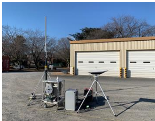
<Starlink をバックホール回線として利用した車載型基地局（左）と可搬型基地局（右）>
